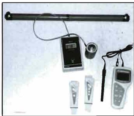
Distintos tipos de conductímetros o sondas para la medida de la CE
