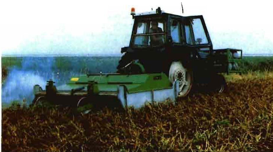
Apero para el deshojado en patata. Una técnica para la lucha contra enfermedades criptogámicas en desinfección de hojas.
