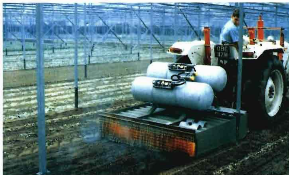
Desherbaje térmico total en presiembra o preplantación bajo invernadero.
