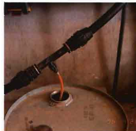
A la izquierda, incorporación del DD a la red de riego mediante un inyector Venturi. En la imagen superior, detalle del Venturi.
