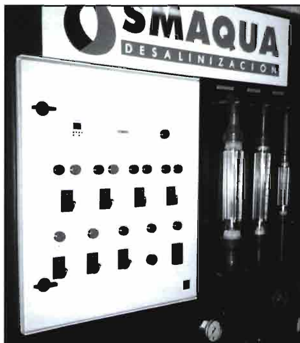
En la foto vertical, desaladora empleada para la obtención de agua de partida libre de iones necesaria para un reciclado total de los lixiviados. Arriba, detalle del ensayo de tomate cv. Rambo sobre perlita. Véase el cubre-suelo de polipropileno de color blanco.
