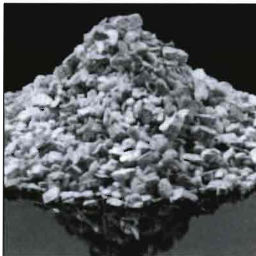
Vermiculita. Materia prima para el componente llamado Termita® de la firma Asfaltex.
