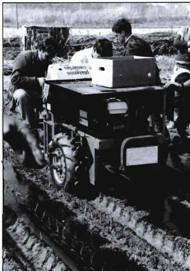
Arriba, motopulverizadora para tratamientos, en este caso la barra colocada en posición horizontal sobre un carro-oruga con cadenas. Abajo, plantadora autopropulsada Dewa trabajando sobre terreno acolchado en plancha con un plantel a raíz desnuda.
