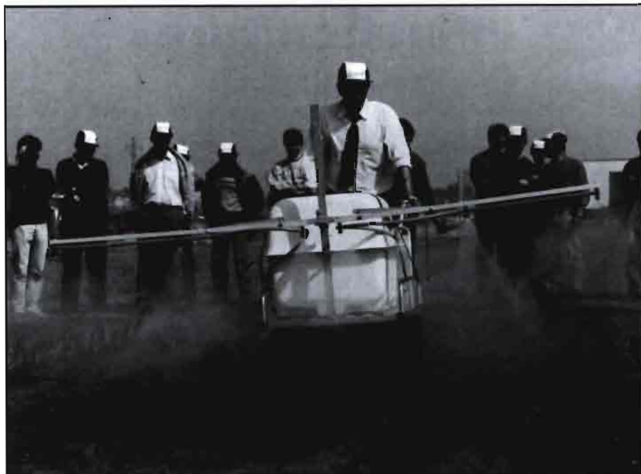
Arriba, motopulverizadora para tratamientos, en este caso la barra colocada en posición horizontal sobre un carro-oruga con cadenas. Abajo, plantadora autopropulsada Dewa trabajando sobre terreno acolchado en plancha con un plantel a raíz desnuda.
