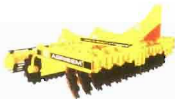
Equipo combinado para labranza reducida Agrisem Disk-O-Mulch, de la empresa Comeca, S.A. Novedad Destacada Fima'05.
