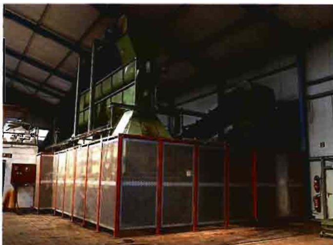
La máquina de vapor da un tratamiento especial que asegura que la turba esté libre de malas hierbas.
