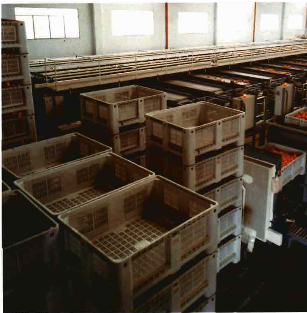
La velocidad de trabajo de la línea es común que se adecue a la condición de los frutos y al tipo de confección con encajado (menor velocidad que con enmallado)
