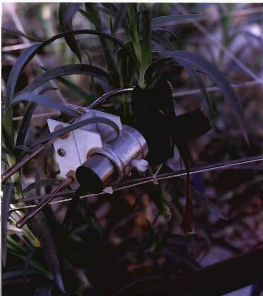
Arriba, cultivo de cyclamen con riego gestionado mediante tensiómetros transductores. Debajo, detalle de un sensor LVDT en clavel cultivado en sacos de perlita.
