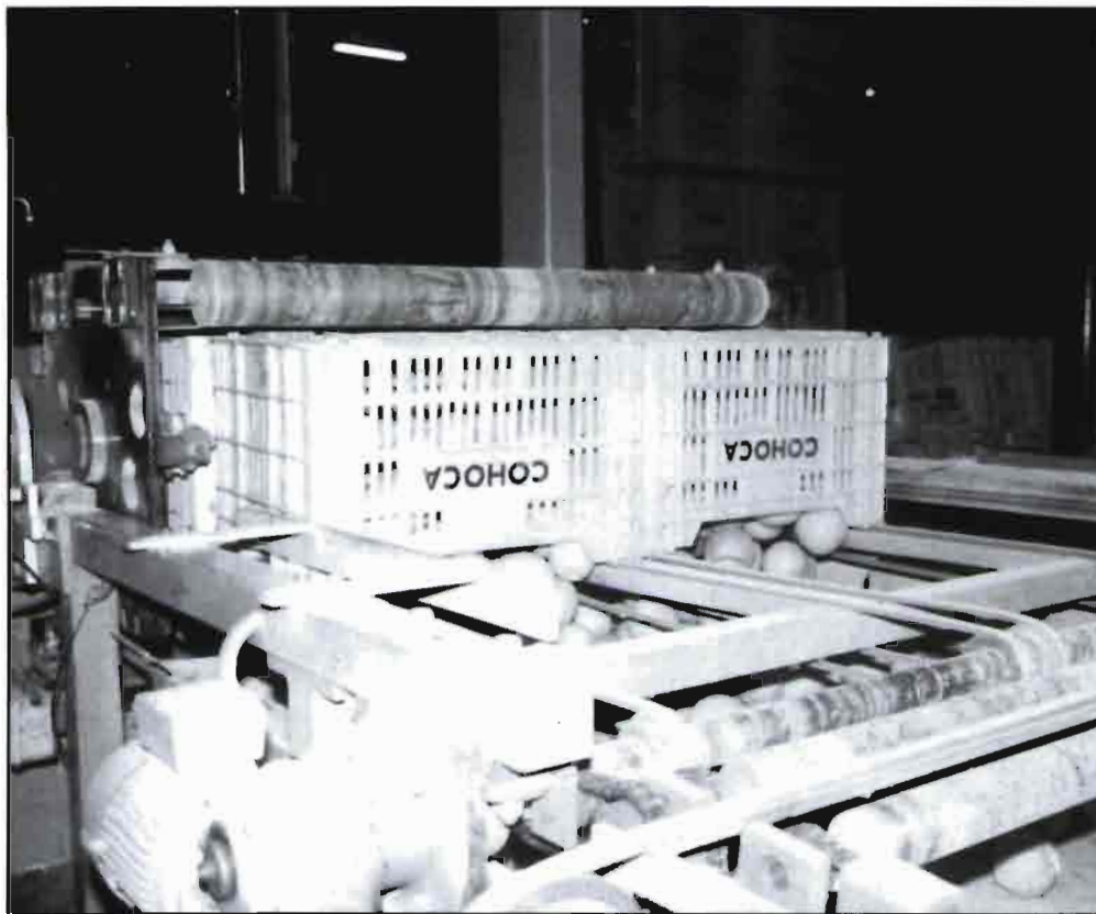
La imagen muestra una despaletizadora-volteadora-apiladora de envases vacíos. Debajo, una flejadora.
