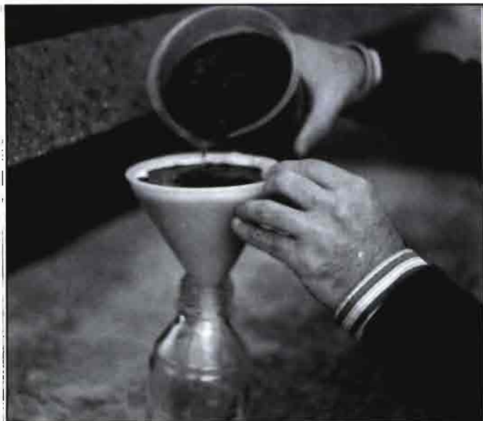
En la fotografía inferior, extracción de nutrientes por agitación. Al lado, filtración del extracto.
