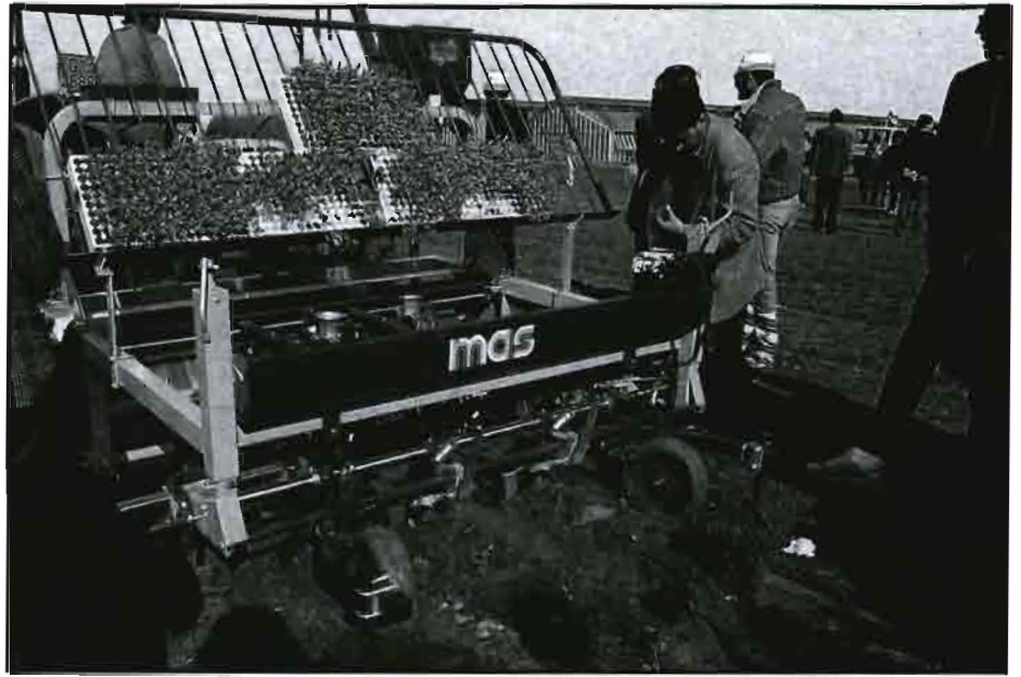
En la máquina de trasplantar y de acolchar de la Mas, se puede apreciar el sistema de calzado de los laterales del plástico de acolchado.
