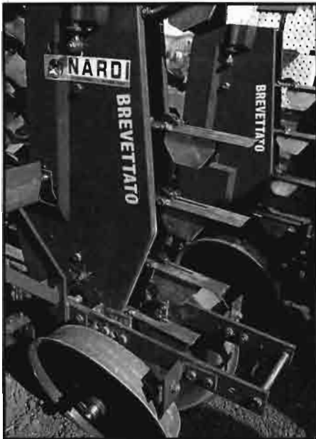
Trasplantadora Nardi, modelo Tuf. Emplea la pinza como elemento de transporte en la máquina.
