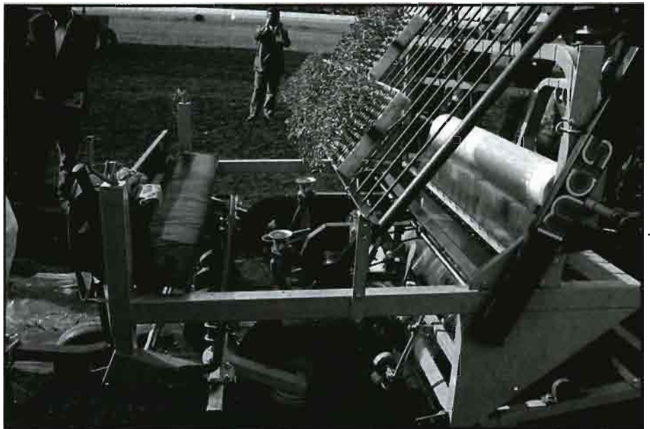
Trasplantadora de la Mas que al mismo tiempo coloca plástico para acolchado.
