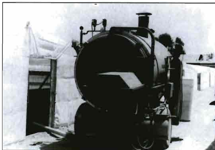
Tanque suministrador de vapor para esterilizar totalmente el sustrato de cultivo.
