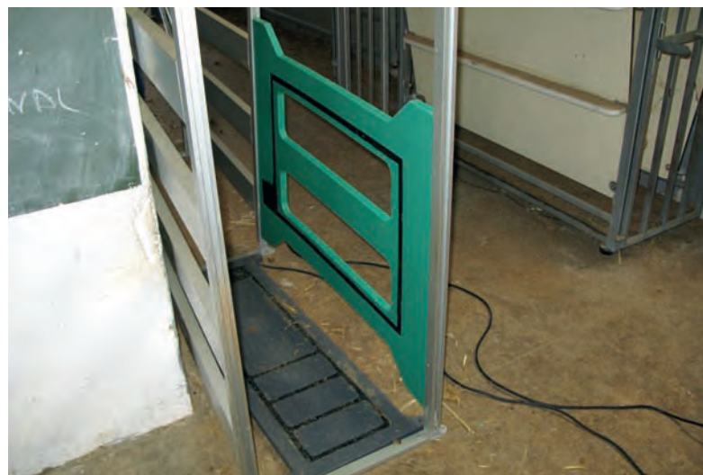
FOTO 2: Antenas utilizadas en la prueba, instaladas en Mangakit
