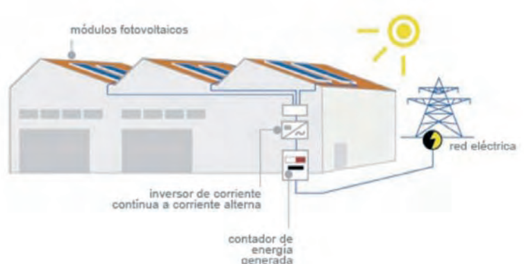
FIGURA 2 / Instalación fotovoltaica en cubierta "CONECTADA A RED"
