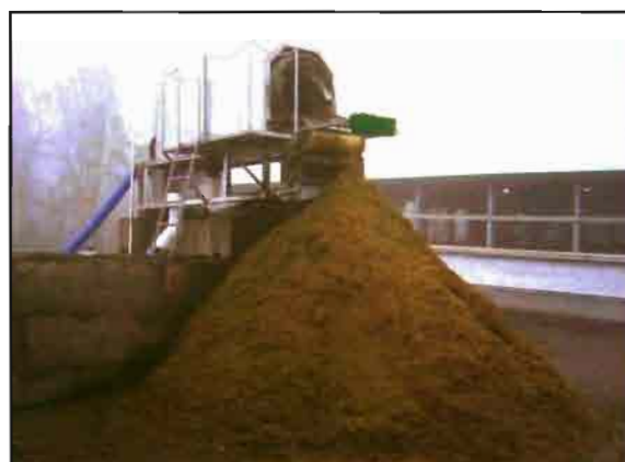
Figura 9. Tamiz rotativo con sistema de presión (ACCENT)
