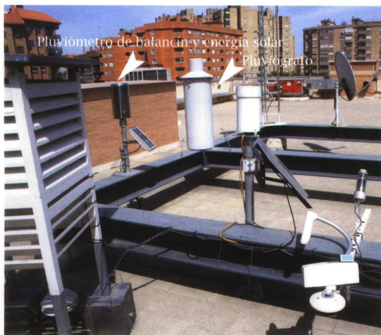
..... Estación meteorológica oficial, donde podemos ver un pluviómetro digital de balancín, y un pluviógrafo.
