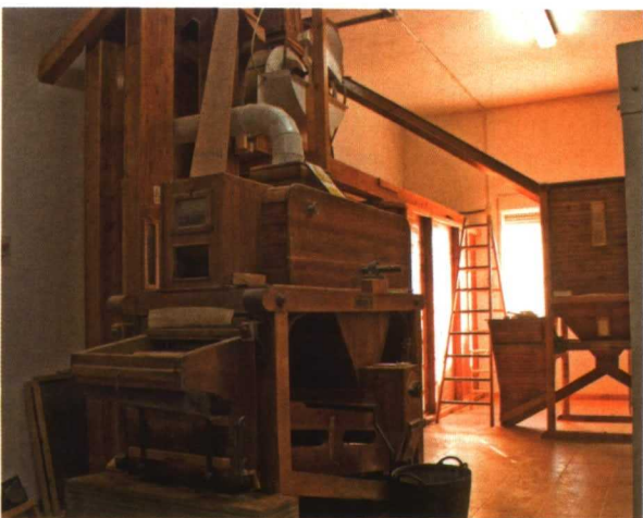
..... Una "limpia" o maquinaria para hacer una primera limpieza del grano, retirando pequeñas piedras, polvo, restos de paja... Al fondo la tolva que alimenta al molino
