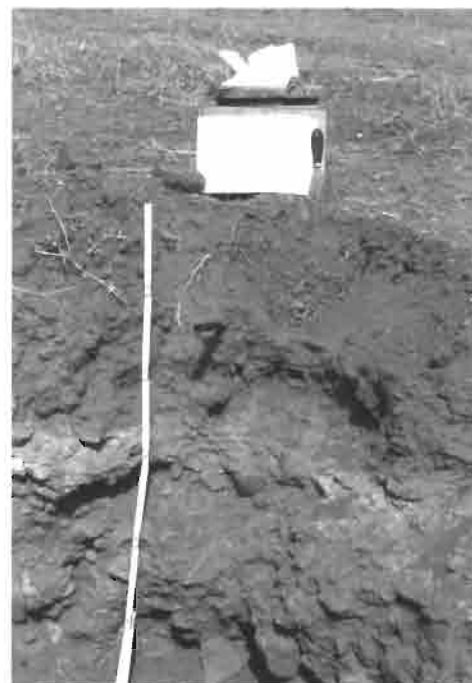
Corte para conocer el grosor y la consistencia de los horizontes del suelo
