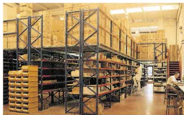
Estantería de carga manual con pasillos elevados.
