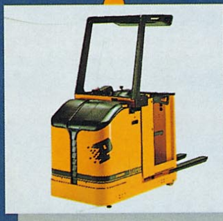
MODO Capacidad: 1.000 kg. Altura: 1 a 7,5 Mts.
