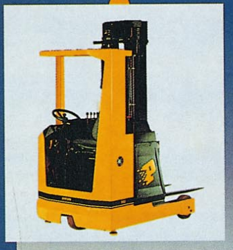
THESI Capacidad: 1.400 a 2.500 kg. Altura: 4,5 a 11,5 Mts.
