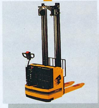
CN Capacidad: 1.300 a 1.600 kg. Altura: 2,5 a 4,5 Mts.
