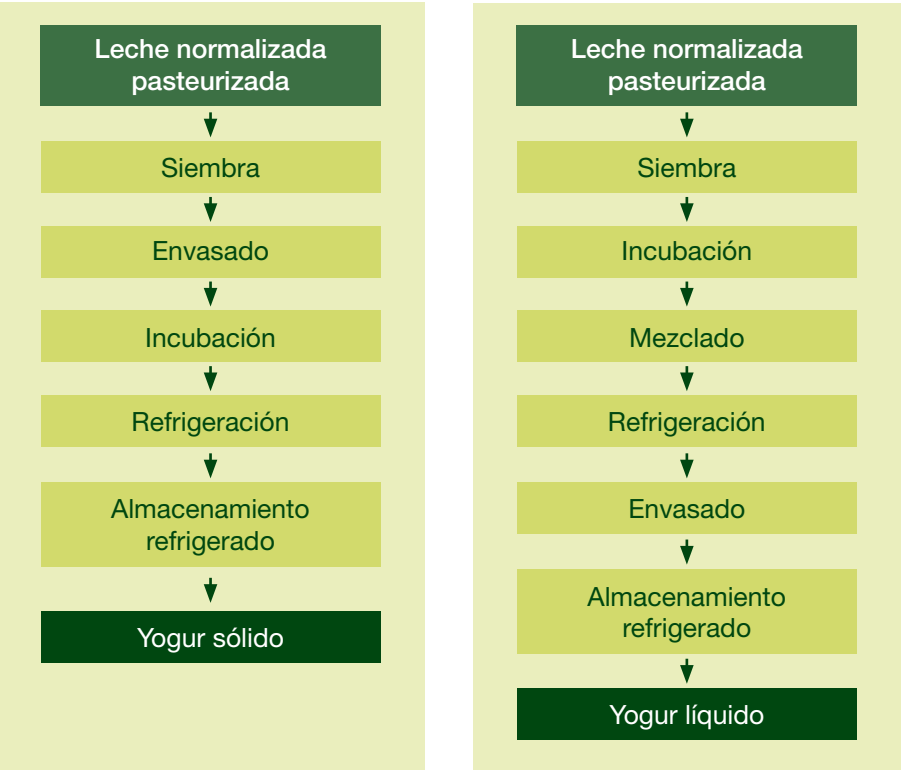
Diagramas 2 y 3. Procesos productivos en elaboración de yogurt sólido y líquido.
