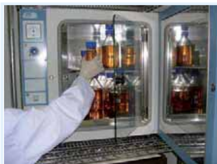
Las botellas inoculadas se incuban a 37°C durante 24-48 horas.
