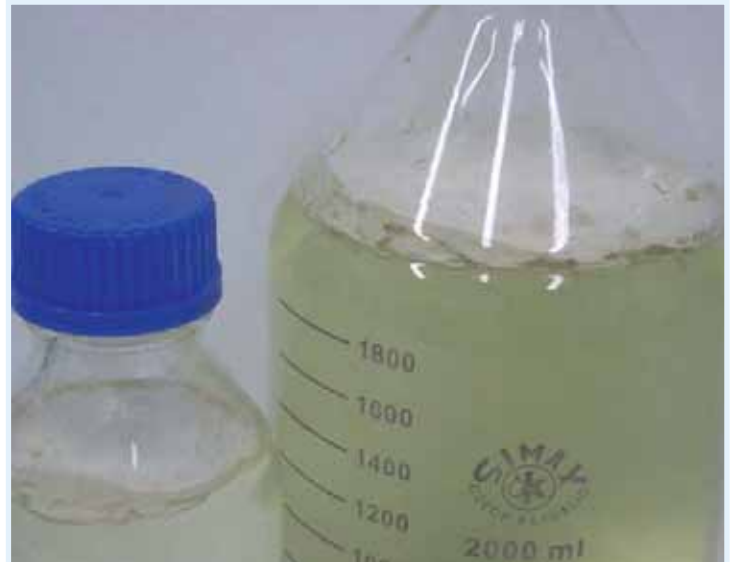
Los medios deshidratados se disuelven en agua destilada.
