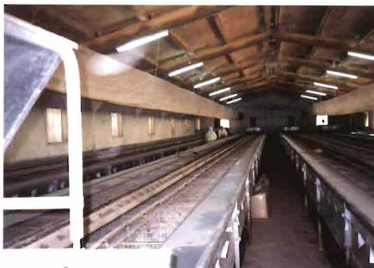
Un sistema de railes guía al carro de distribución de pienso hacia cada una de las líneas de jaulas
