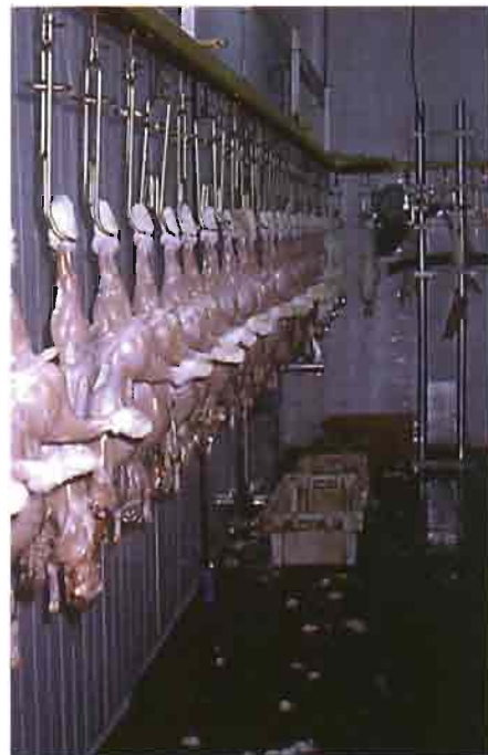
En el matadero Alto Jiloca la línea de sacrificio posee una capacidad para 600 conejos a la hora.
