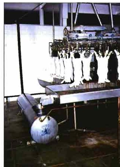
La sangre es recogida en un tanque adecuado, vaciándose por bombeo.
