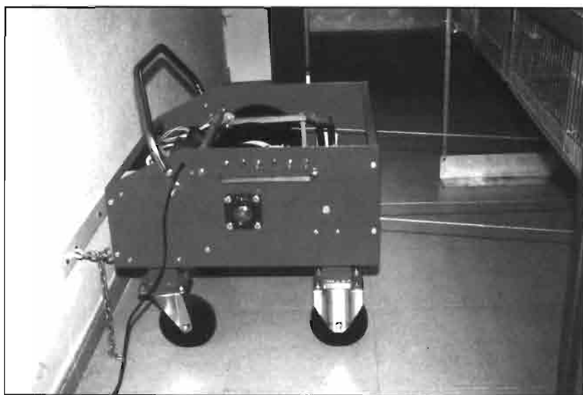
Fig 1.- Detalle del robot móvil. Obsérvese el enganche a la pared mediante una barra metálica. El robot dispone de ruedas y un asa para ser trasladado de una hilera a otra con toda comodidad. En la parte inferior se observan dos cables tractores, y en la superior el cable de retroceso.
