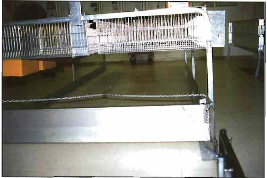
Fig. 4.- Es lógico que la pala esté situada dentro de las fosas o guías para evitar desplazamientos laterales. Estas guías pueden estar situadas a cualquier altura, de acuerdo con las exigencias de cada conejar
