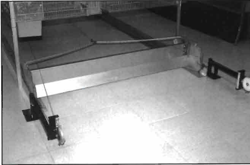
Fig. 2.- Detalle de los enganches metálicos con sus poleas, fijados en el suelo o en una superficie firme al final de cada una de las líneas. Obsérvense los dos cables tractores sobre cada una de las poleas, y el cable de retroceso unido por unas cadenas.
