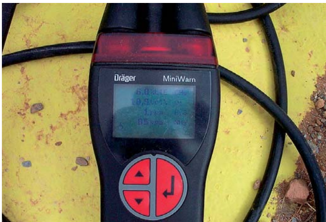
Aparato para la medición de la concentración de gases
