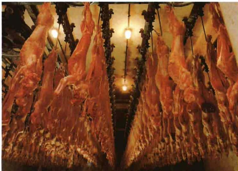
Fig. 1 Para la buena elaboración de la carne las canales recién desolladas deben permanecer durante horas en el frigorífico, para que se produzca una correcta desecación superficial y se logre el grado de acidez idóneo del músculo. Cámara frigorífica de uno de los primeros mataderos de conejos homologados por la CEE en la Almunia del Penedés.
