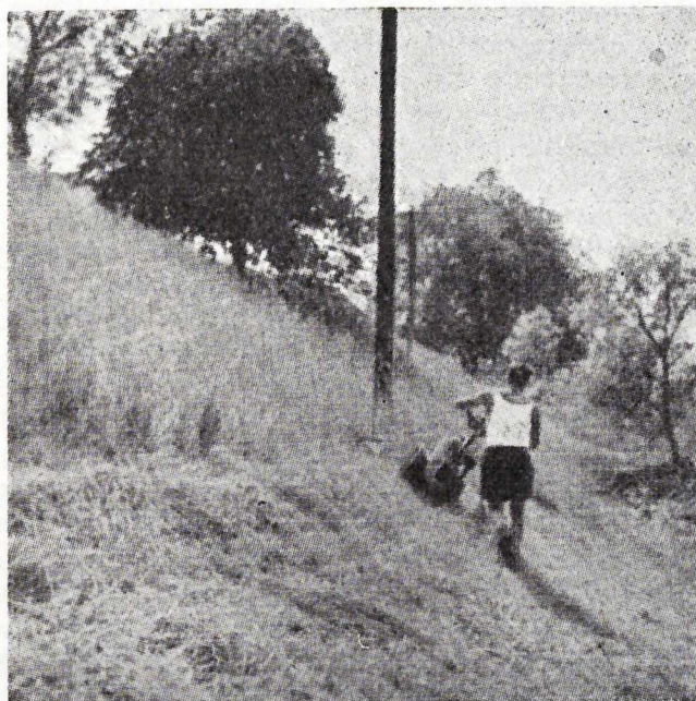
Segadora empleada en pendientes del 70 por 100. Está provista de ruedas adicionales estriadas, para aumentar la adherencia.
