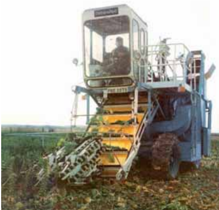
FIGURA 5.- RECOLECCIÓN DE PIMIENTO MEDIANTE PEINADO (CÁCERES, 1980)
