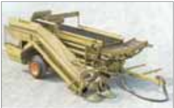
FIGURA 7.- COSECHADORA DE TOMATE ARRASTRADA
