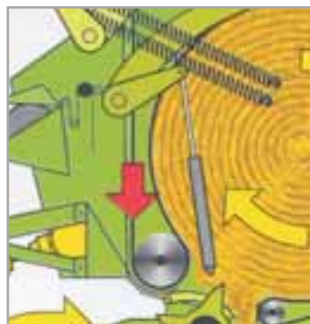
FIGURA 12.- ENTRADA DEL HILO O DE LA RED PARA EL ATADO
