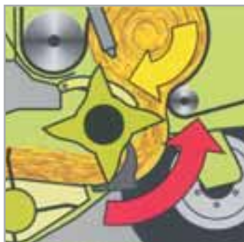
FIGURA 18.- ALIMENTADOR ROTATIVO Y CUCHILLAS DE PICADO
