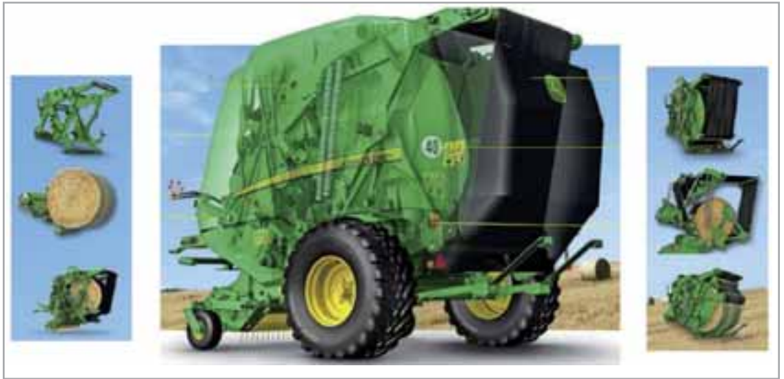
FIGURA 14.- SISTEMA DE APERTURA RÁPIDA DE LA CÁMARA CON LATERALES MÓVILES
