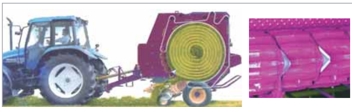
FIGURA 21.- EMPACADORA DE CÁMARA VARIABLE CON CUCHILLAS DE PICADO RETRÁCTILES PARA LA CAPA FINAL
