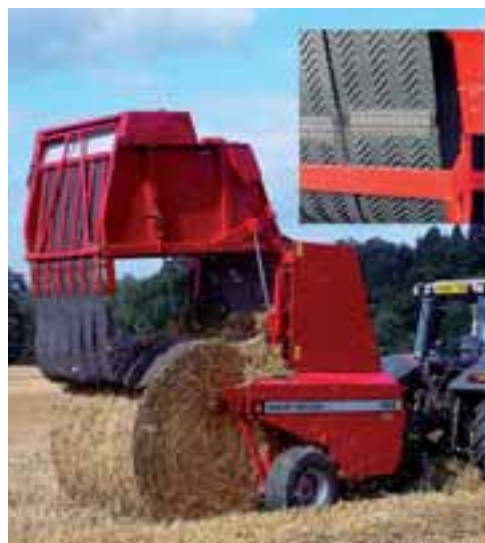
FIGURA 6.- ROTOEMPACADORA DE CÁMARA VARIABLE CON CORREAS DE GOMA
