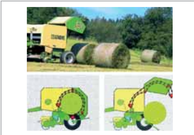
FIGURA 10.- ROTOEMPACADORA DE CÁMARA SEMI-FIJA CON TRES RODILLOS ARTICULADOS PARA REDUCIR EL TAMAÑO DE LA CÁMARA EN EL INICIO DE LA FORMACIÓN DE LA PACA
