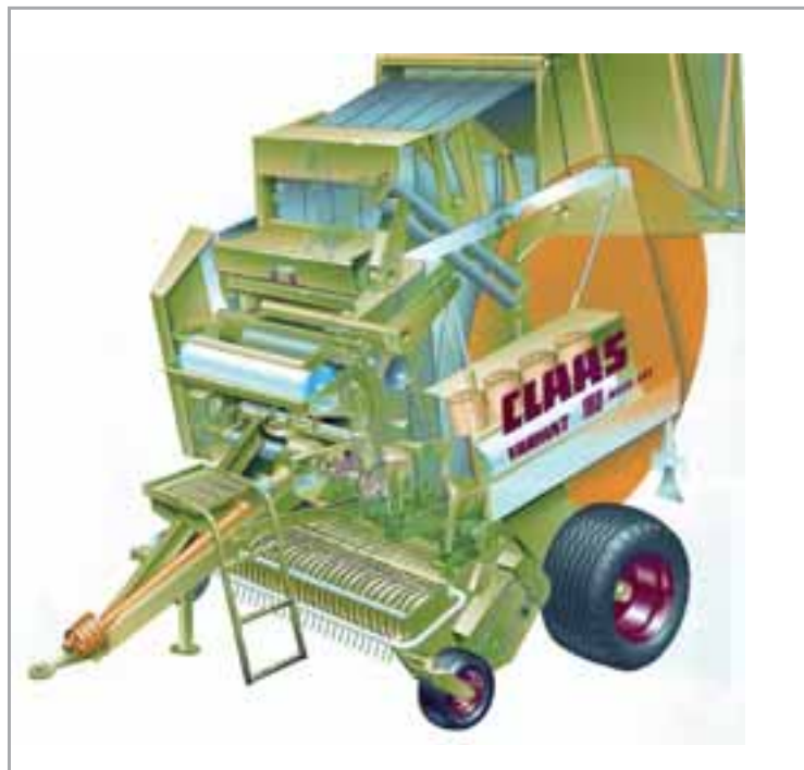
FIGURA 25.- ROTOEMPACADORA DE CÁMARA FIJA-VARIABLE
