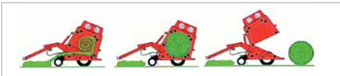
FIGURA 2b.- PROCESO DE FORMACIÓN DE LA PACA CON CÁMARA VARIABLE
