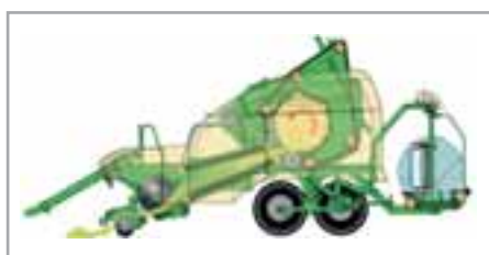
FIGURA 23.- ROTOEMPACADORA-ENVOLVEDORA CON PRE-CÁMARA ACCIONADA MEDIANTE CINTAS TRANSPORTADORAS
