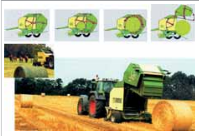
FIGURA 9.- ROTOEMPACADORA DE CÁMARA FIJA MEDIANTE CADENA DE BARRAS
