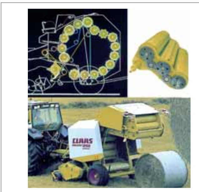
FIGURA 10.- ROTOEMPACADORA DE CÁMARA SEMI-FIJA CON TRES RODILLOS ARTICULADOS PARA REDUCIR EL TAMAÑO DE LA CÁMARA EN EL INICIO DE LA FORMACIÓN DE LA PACA
