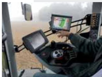
La versión CEBIS incluye un sistema de gestión en cabeceras con control de implementos (CSM).
