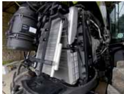
El nuevo ventilador Visctronic, controlado electrónicamente, proporciona la potencia de refrigeración adecuada para unificar la temperatura de todos los elementos de los radiadores, lo que conlleva un ahorro de combustible.
