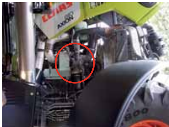
El motor incluye un turbo de geometría variable (exclusivo para Claas de FPT).
