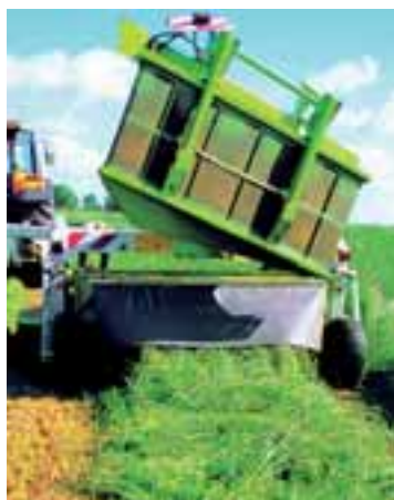
FIGURA 8.- CINTA TRANSPORTADORA QUE PERMITE AGRUPAR CORDONES DE FORRAJE (NO CONECTADA)
