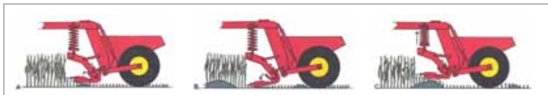
FIGURA 8.- CINTA TRANSPORTADORA QUE PERMITE AGRUPAR CORDONES DE FORRAJE (NO CONECTADA)
