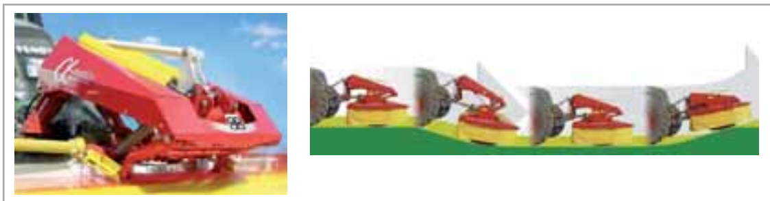
FIGURA 9.- DISPOSITIVO PARA PROTECCIÓN DE LOS DISCOS FRENTE A LOS OBSTÁCULOS
