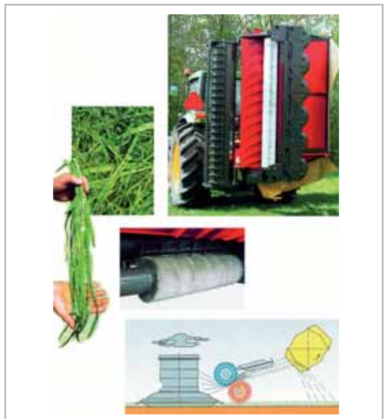
FIGURA 4.- ACONDICIONADO INTENSIVO MEDIANTE CILINDRO DE PÚAS DE NYLON
