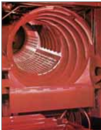
FIGURA 2.- CÁMARA DEL ROTOR EN LA AXIAL FLOW
