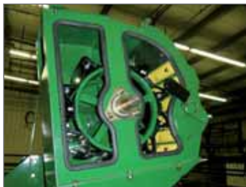
FIGURA 12.- RETRILLA DE GRANZAS EN LA COSECHADORA DE FLUJO AXIAL (JOHN DEERE SERIE S)
