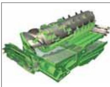
FIGURA 13.- CILINDRO TRILLADOR-SEPARADOR DE LA COSECHADORA 7545 RTS QUE HA SIDO COMERCIALIZADA POR DEUTZ-FAHR
