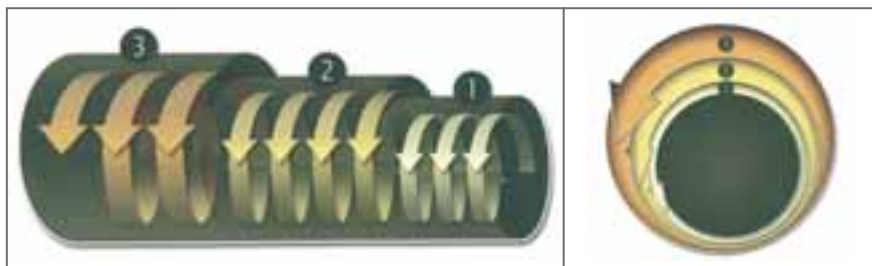
FIGURA 9.- ZONAS DE ENTRADA, TRILLA Y SEPARACIÓN (JOHN DEERE S960)
