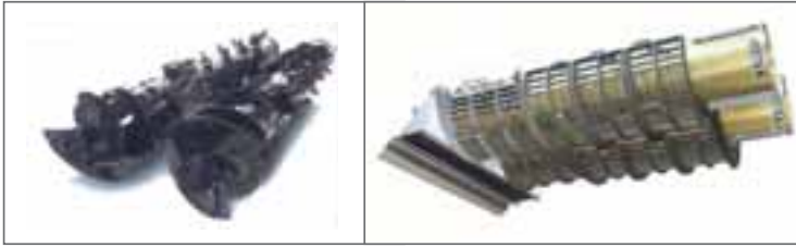
FIGURA 15.- ROTORES Y CÓNCAVOS DE LA COSECHADORAS NEW HOLLAND DE LA SERIE CR 9000 ELEVATION
