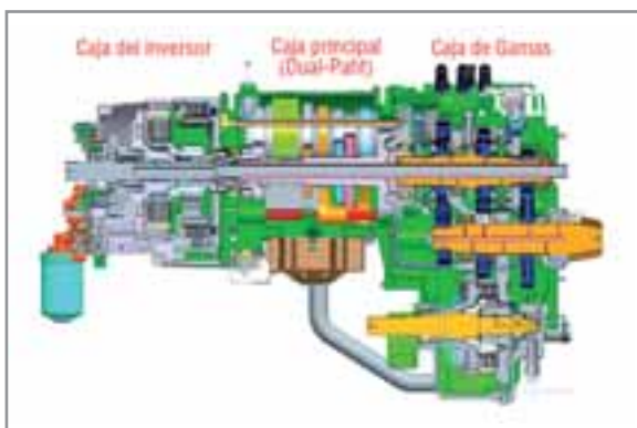
FIGURA 1.- MÓDULOS QUE COMPONEN LA TRANSMISIÓN DIRECTDRIVE
