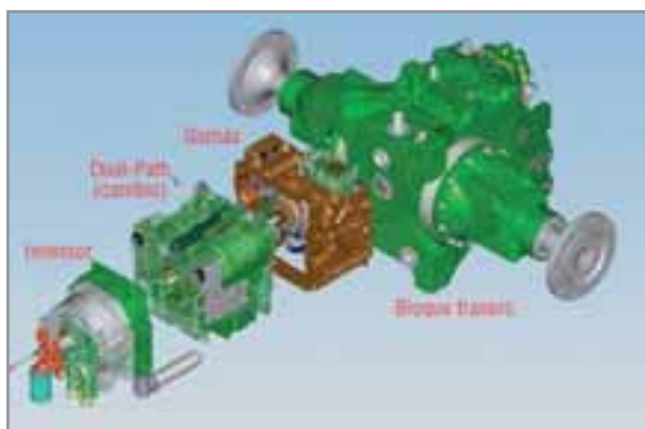
FIGURA 1.- MÓDULOS QUE COMPONEN LA TRANSMISIÓN DIRECTDRIVE
