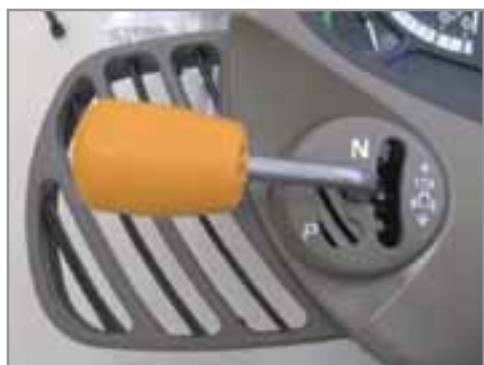
FIGURA 7.- CONTROL DEL INVERSOR CON NEUTRAL Y BLOQUEO
