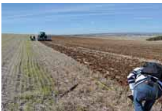
Las pruebas de resbalamiento se realizaron en distancias de 100 m con la grada de discos a diferentes profundidades.
