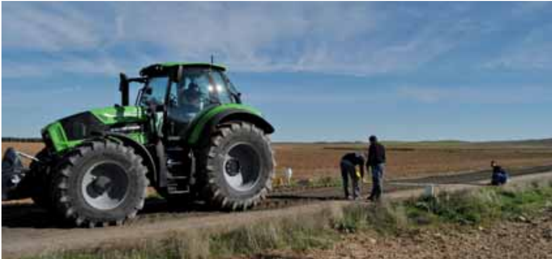
El adelanto del eje delantero se midió en un camino llano situado junto al Centro de Formación de SDF Ibérica en Toledo.
