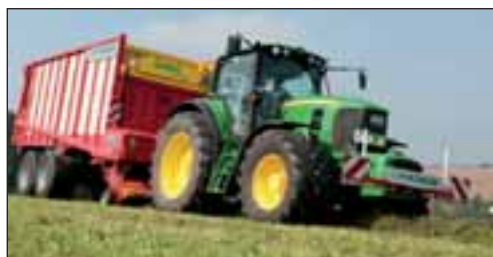
Unión ISO-BUS Clase 3 entre tractor y remolque autocargador.
