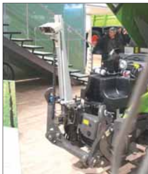
Sistema de visión artificial sobre un tractor.
