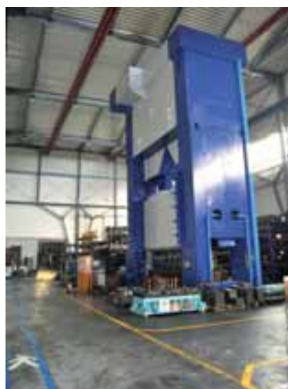
Prensa de mayor tamaño en la fábrica de Unicka, con una capacidad de carga de 5 000 toneladas.
