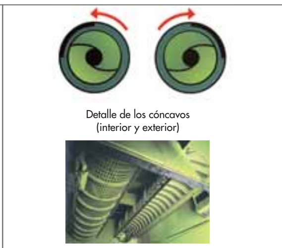
FIGURA 13.- SEPARACIÓN RESIDUAL ACTIVA DE CLAAS
