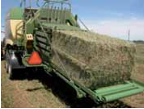
Cilindros hidráulicos en la parte superior y en los laterales de la cámara de compresión.
