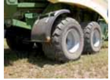
Hay disponibles dos versiones de ejes, para 13 y 16 t, esta última con neumáticos 71045 R26.5
