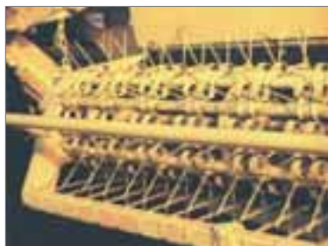
FIGURA 4.- PEINADO MEDIANTE PÚAS
