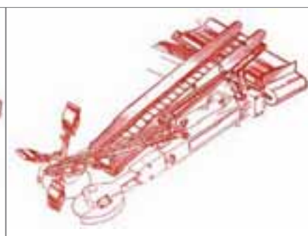
FIGURA 9.- UNIDAD DE SIEGA SITUADA SOBRE BASTIDOR UNIVERSAL (NIAE)
