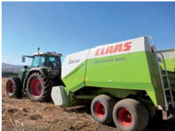
Figura 4: Empacadora Claas Quadrant 2100 con cabezal astillador T-2400 de Serrat
