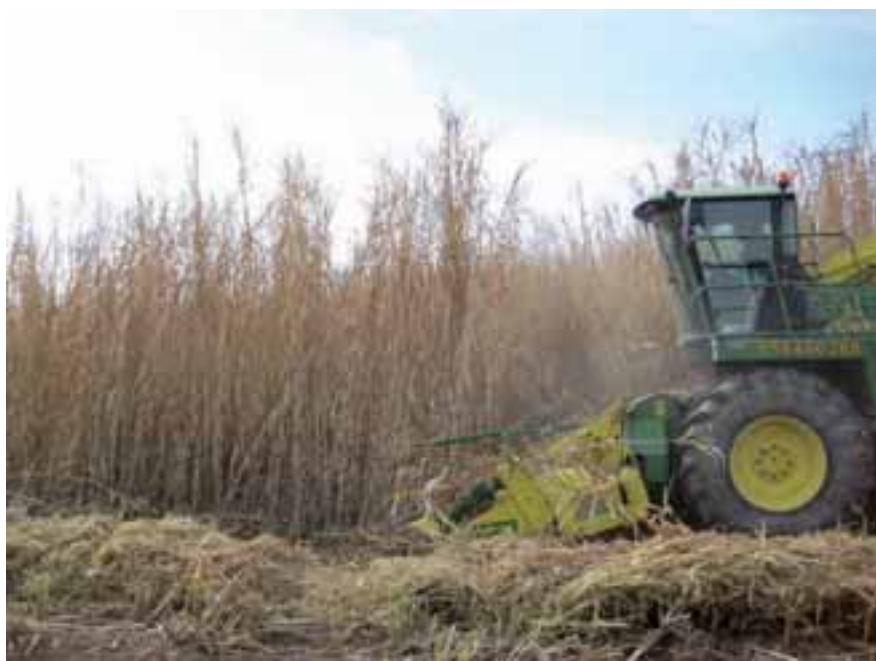
Figura 6: Picadora con cabezal Champion 450 trabajando en la plantación de caña común.
