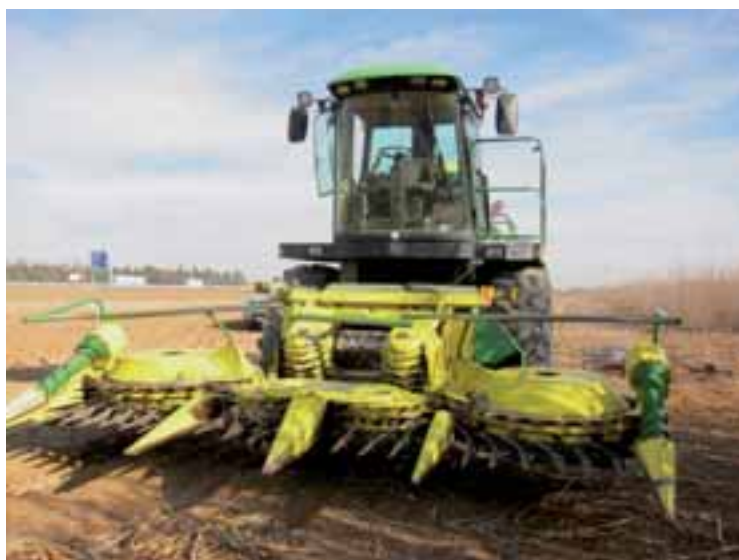
Figura 3: Picadora John Deere de 430 CV equipada con cabezal Kemper Champion 450.
