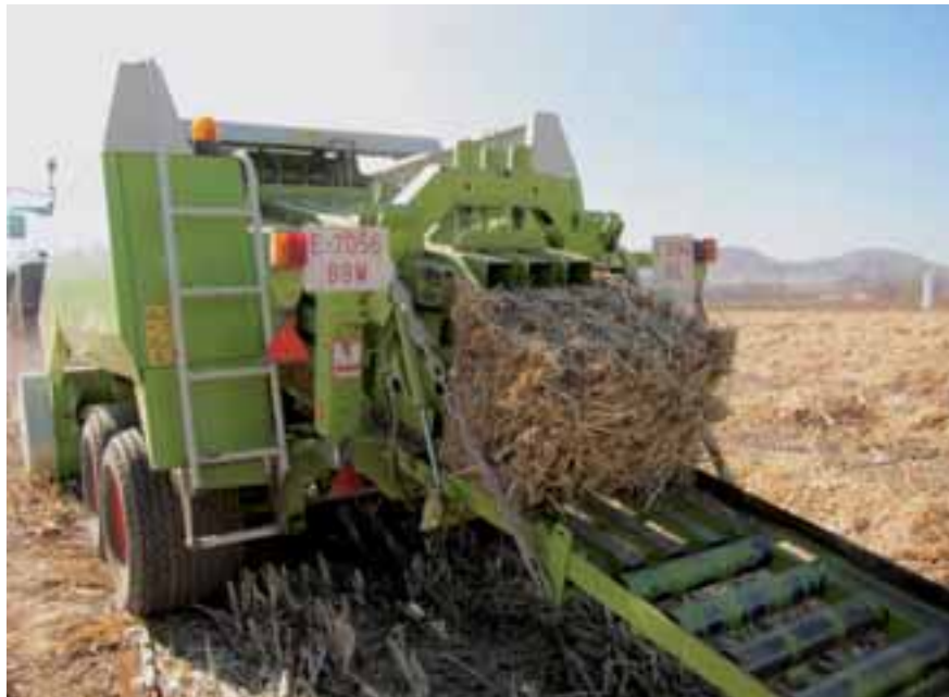
Figura 7: Empacadora Claas Quadrant 2100 liberando una paca de biomasa de caña común.
