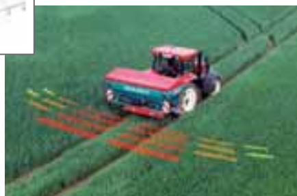
El sistema Econov gestiona el reparto de la capa de abono teniendo en cuenta su forma real de 'croissant'.
