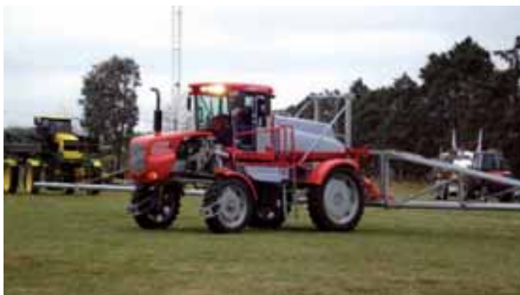
FIGURA 09.- PULVERIZADOR AUTOPROPULSADO CARACTERÍSTICO DE SUDAMÉRICA (FAVOT)
