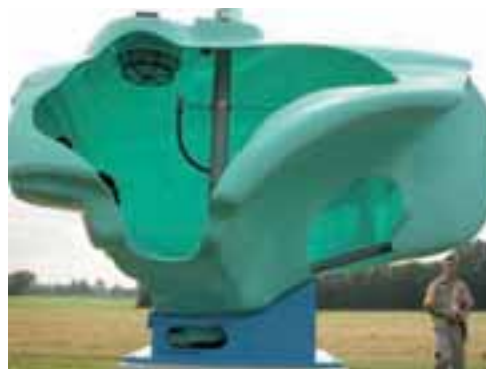
FIGURA 11.- DEPÓSITO CON FORMA DE PIRÁMIDE INVERTIDA PARA MINIMIZAR EL VOLUMEN RESIDUAL (BERTHOUD)
