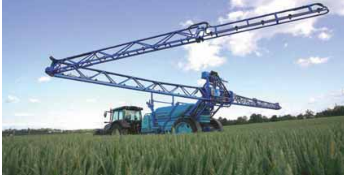
FIGURA 07.- SISTEMA PARA EL PLEGADO DE LAS BARRAS Y REGULACIÓN DE SU ALTURA CON RESPECTO AL PLANO DE PULVERIZACIÓN
