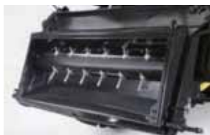
El nuevo canal de alimentación incluye el sistema Extra Feeding con un cilindro con dedos retráctiles.
