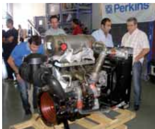
Algunos asistentes observan el motor de 4 cilindros modelo 1204E-E44TA (61.5-110.1 kW), perteneciente a la Serie 1200.
