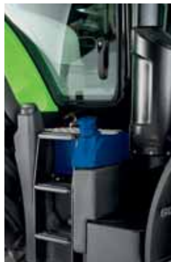
El motor Deutz de 6 cilindros incluye la tecnología SCR que utiliza AdBlue.
