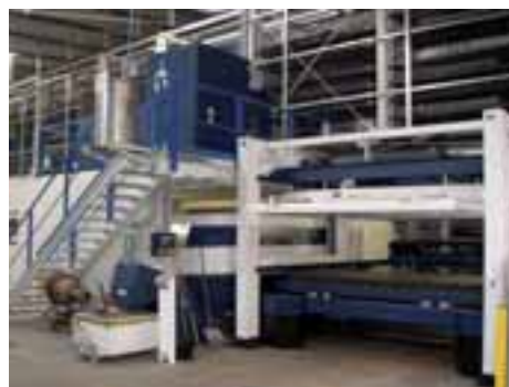
Cortadora láser con almacenamiento automático.
