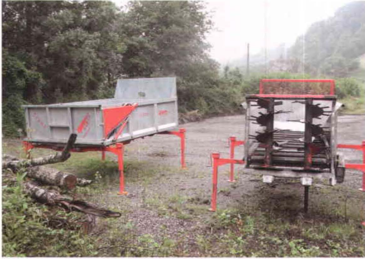
Figura 2.- Caja de remolque y de esparcidor de estiércol para colocar sobre una transportadora.
