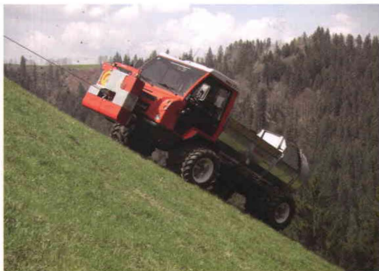
Figura 5.- Transportadora ascendiendo con el cablestante
