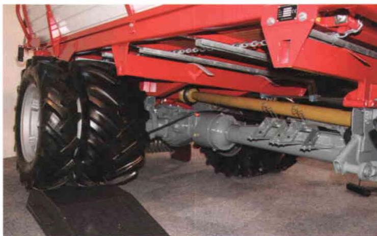
Figura 4.- Efecto del bastidor oscilante
