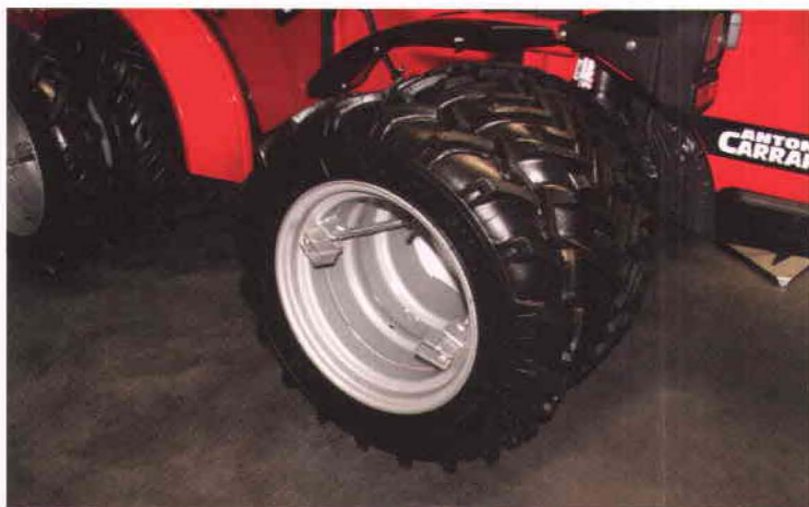
Figura 9.- Rueda gemela con acoplamiento rápido
